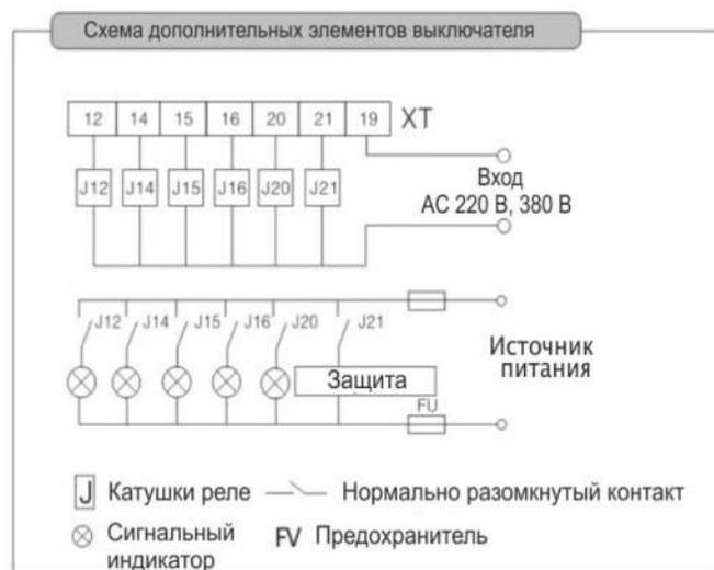
1. Поступление сигнала контроллера на контакты the controller 12,14~ 16, 20, 21, приводит к передаче сигнала на выходные контакты.
