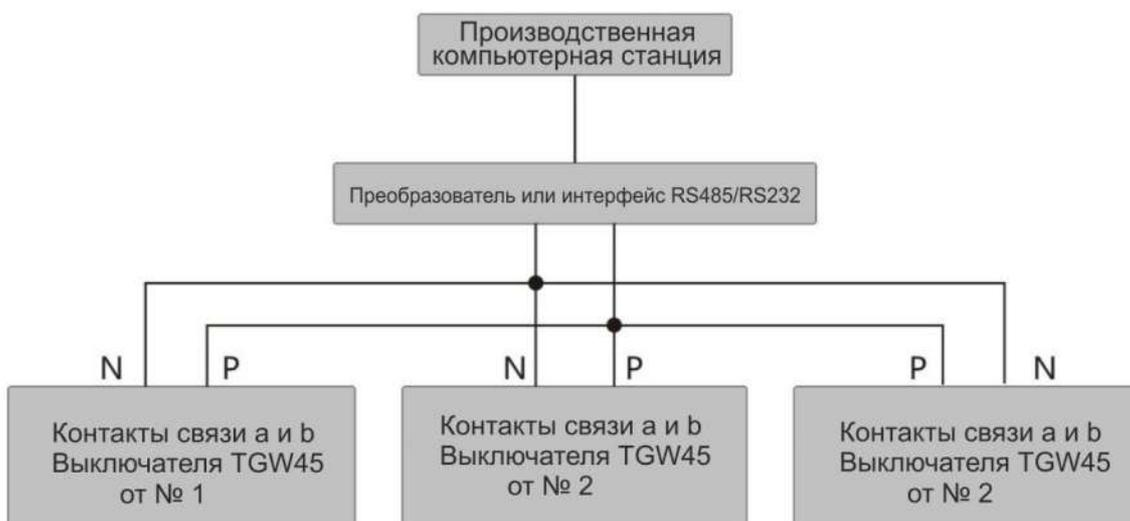
**Диаграмма соединения выключателей с общим протоколом DP выглядит следующим образом:**
